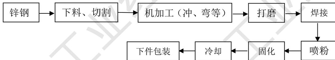
图 6-1 镀锌铁艺栅栏生产工艺流程图
